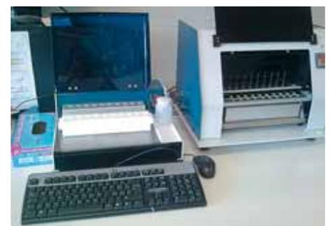
Figura 3 Lattodinamografo
