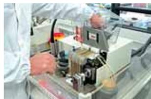
La soluzione così preparata è pronta ad essere confezionata nelle paillettes con una infialatrice automatica (sistema IS4) che le riempie mediante aspirazione, le salda successivamente con un meccanismo ad ultrasuoni e ne stampa i dati: nome del toro, matricola ufficiale, codice del centro, data di raccolta, razza.
